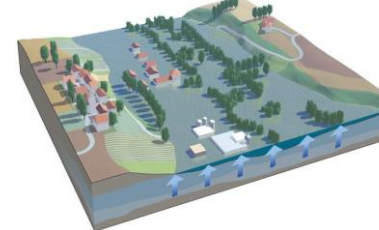
inondation de nappe
